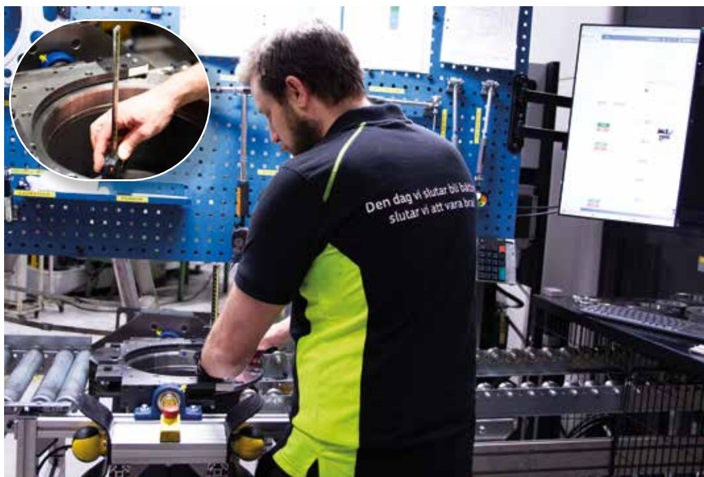
Mathias kontrollerar att navkåpan håller måttet vid mätstationen.
